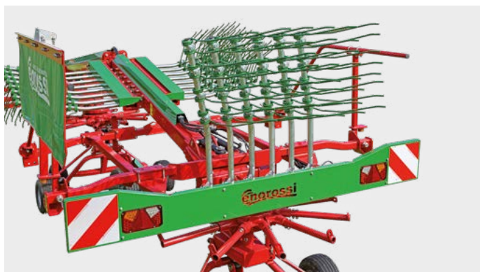
Raking arms and guards disassembled positioned in the appropriate housing. Bras et protections démontés positionnés dans le logement approprié.
