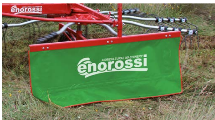
Lateral guard for windrow formation. Déflecteur latéral pour la formation de l'andain.
