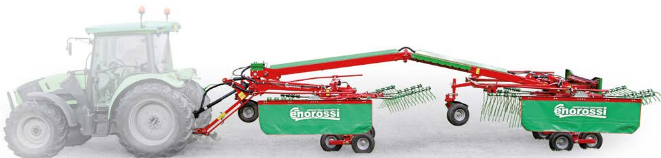
Tracer 780 in transport configuration with raking arms and guards mounted. Tracer 780 dans la configuration de transport avec bras et déflecteurs montés.
