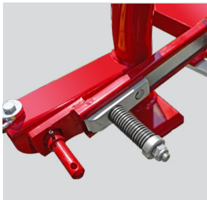
Safety release in case of collision with obstacles. Déclenchement de sécurité en cas de collision avec des obstacles.
